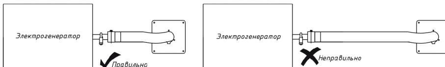
**3.5** Выбор адаптера с заниженным условно проходным диаметром относительно диаметра выхлопного патрубка также может существенно увеличивать сопротивление для отвода газов.
